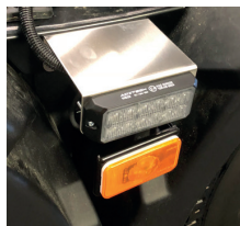
U-fäste för montering av MS26 tillsammans med positionsljus på sida
